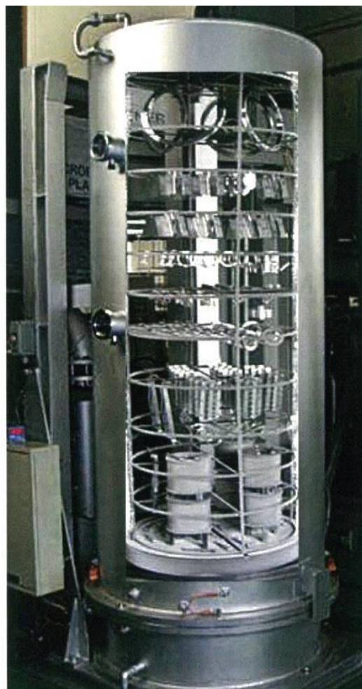
窒化炉 炉内の処理品設置例
