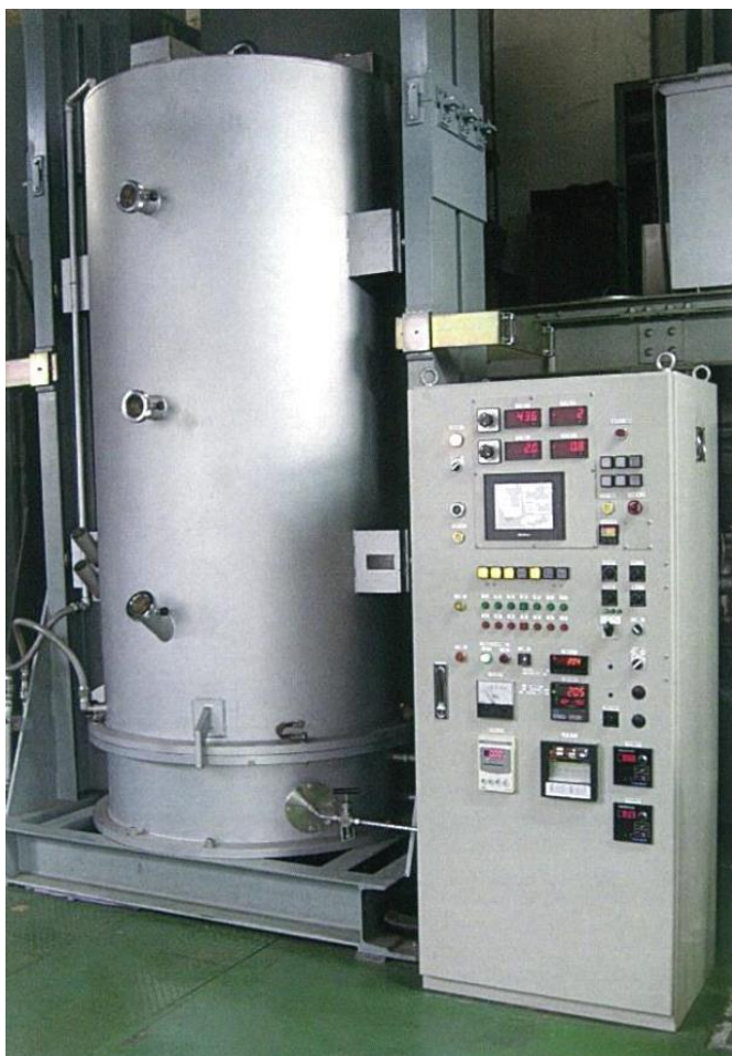
プラズマ窒化炉と制御盤
