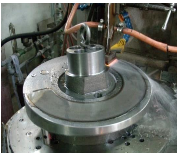
専用焼入れ機による高周波移動焼入れ (FC300 プレーットの面焼入れ)
